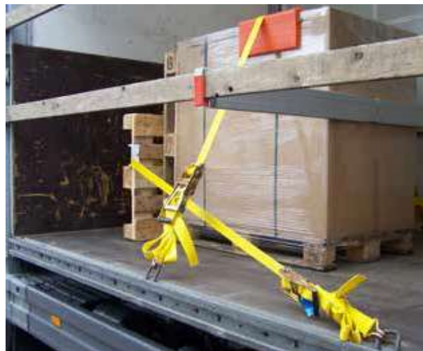
Kombination aus Kopf-Lashing und Niederzurrung
